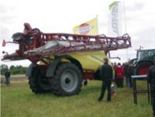
Hardi Commander växtskyddspruta med antingen 3 200, 4 400 eller 6 600 liters behållare. Arbetsbredd är 18 till 36 meter. Vattnet och bekämpningsmedlet blandas effektivt med ChemChiller tekniken och det går snabbt att fylla sprutan – 800 l/minut.
