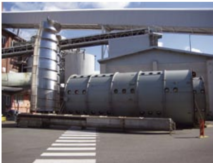
Snitselpressen är 20 m hög och väger 100 ton. Investeringen kostade 400 000 €. Nu räcker presskapaciteten till.
