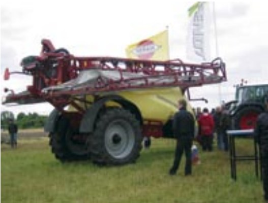
Hardi Commander kasvinsuojeluruiskun saa 3 200, 4 400 ja 6 600 litran säiliöllä. Työleveys on 18–36 metriä. Vesi ja torjunta-aineet sekoittuvat tehokkaasti ChemChiller tekniikan avulla ja ruiskun täyttö on nopeaa – 800 l minuutissa.
