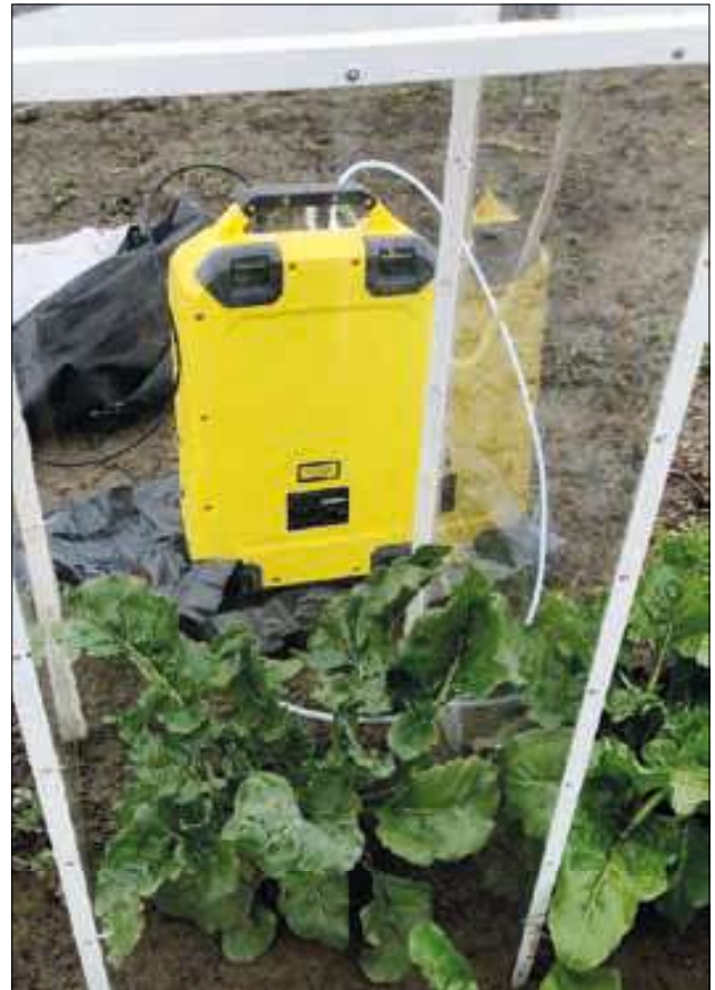
Kuva 1. Läpinäkyvä mittauskammio, jonka sisällä on yksi juurikas. Taustalla keltainen Gasmeter GT 5000 Terra-mittari, joka mittaa kammion CO 2 , CH 4 , N 2 O, NH 3 ja CO-kaasujen pitoisuuksia (ppm). Mittausajat vaihtelivat 10–15 minuuttia.
