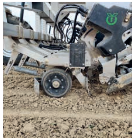
Kuva 2. Vasemmalla: Tanskalaisen FarmDroid ApS:in FarmDroid FD 20 -harausrobotti käyttäen kylvön yhteydessä kerättyä tietoa siementen sijainnista harauskuokkien säätelyyn. Tämä mahdollistaa harauksen riviltä ja rivien välistä valaistusolosuhteista riippumatta. Oikealla: Lähikuva harauskuokista. (Kuvat: Sebastian Streit)
