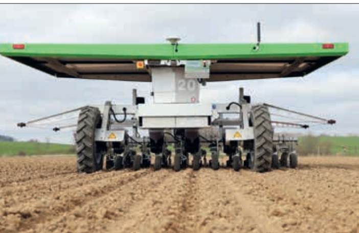
Kuva 2. Vasemmalla: Tanskalaisen FarmDroid ApS:in FarmDroid FD 20 -harausrobotti käyttäen kylvön yhteydessä kerättyä tietoa siementen sijainnista harauskuokkien säätelyyn. Tämä mahdollistaa harauksen riviltä ja rivien välistä valaistusolosuhteista riippumatta. Oikealla: Lähikuva harauskuokista. (Kuvat: Sebastian Streit)
