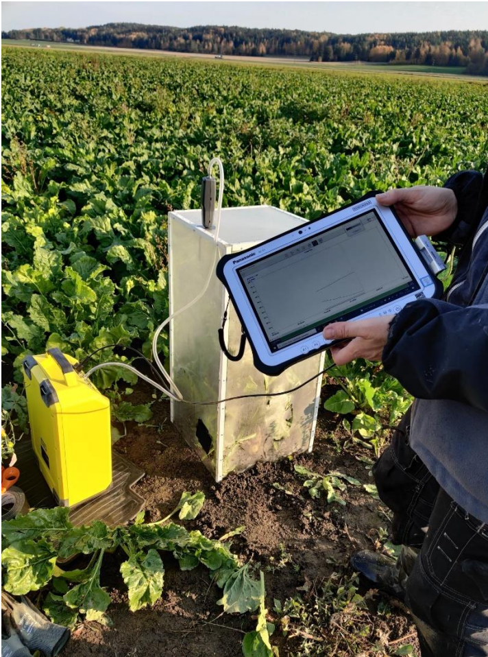
Kuva 13. Gasmeter-kasvihuonekaasumittari, joka tuottaa ajantasaista tietoa kasvihuonekaasujen sitoutumisesta ja haihtumisesta ilmakehään. Kuvassa mittauskammio ja tabletti, jonka kautta mittauslaitetta operoidaan.
