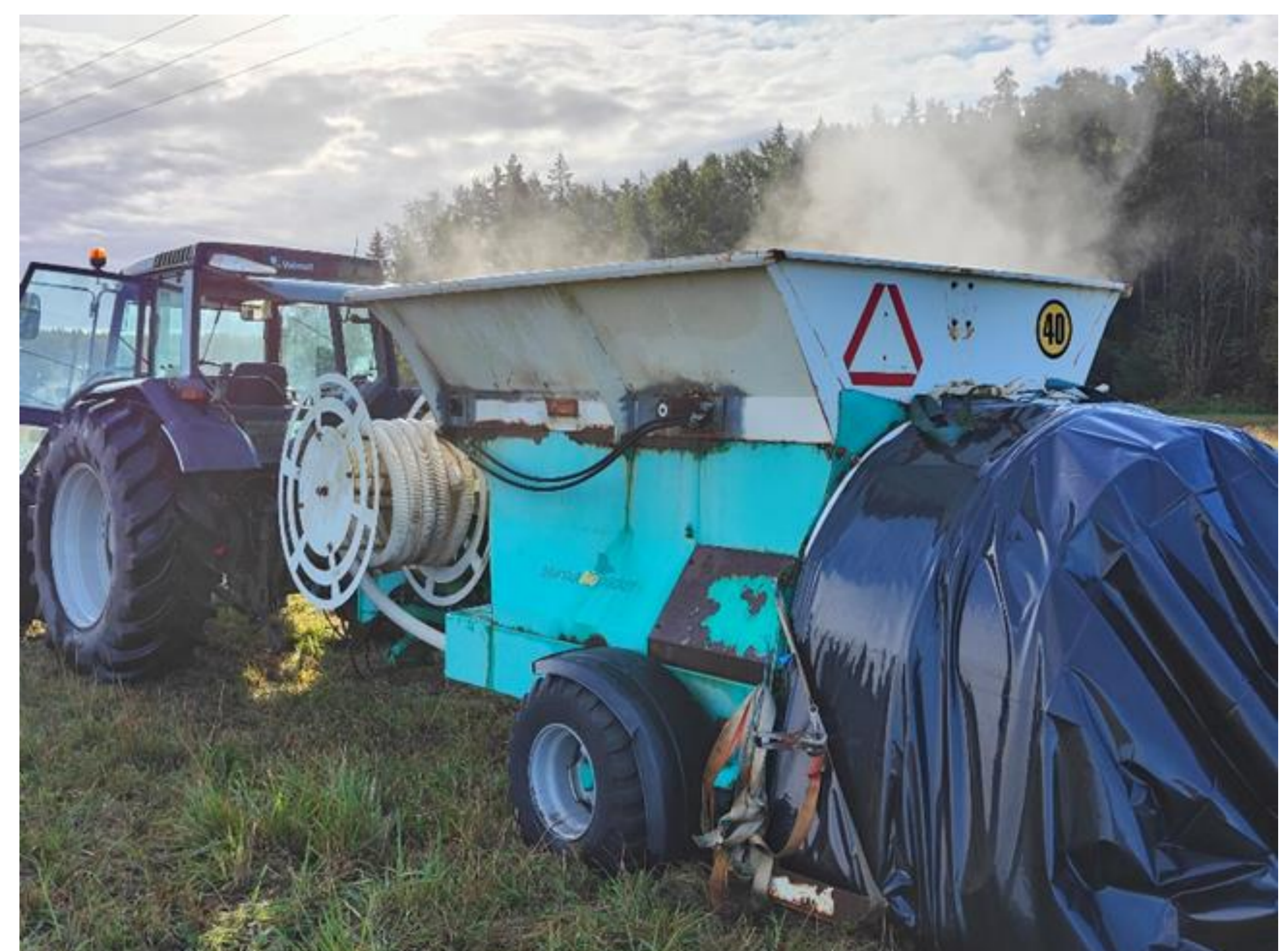
Kuva 3. Biopacker-tuubituskone pakkasi apevaunussa sekoitettua ja pikakompostoitua naattilantakompostia muovituubiin Paimiossa 11.9.2024.
