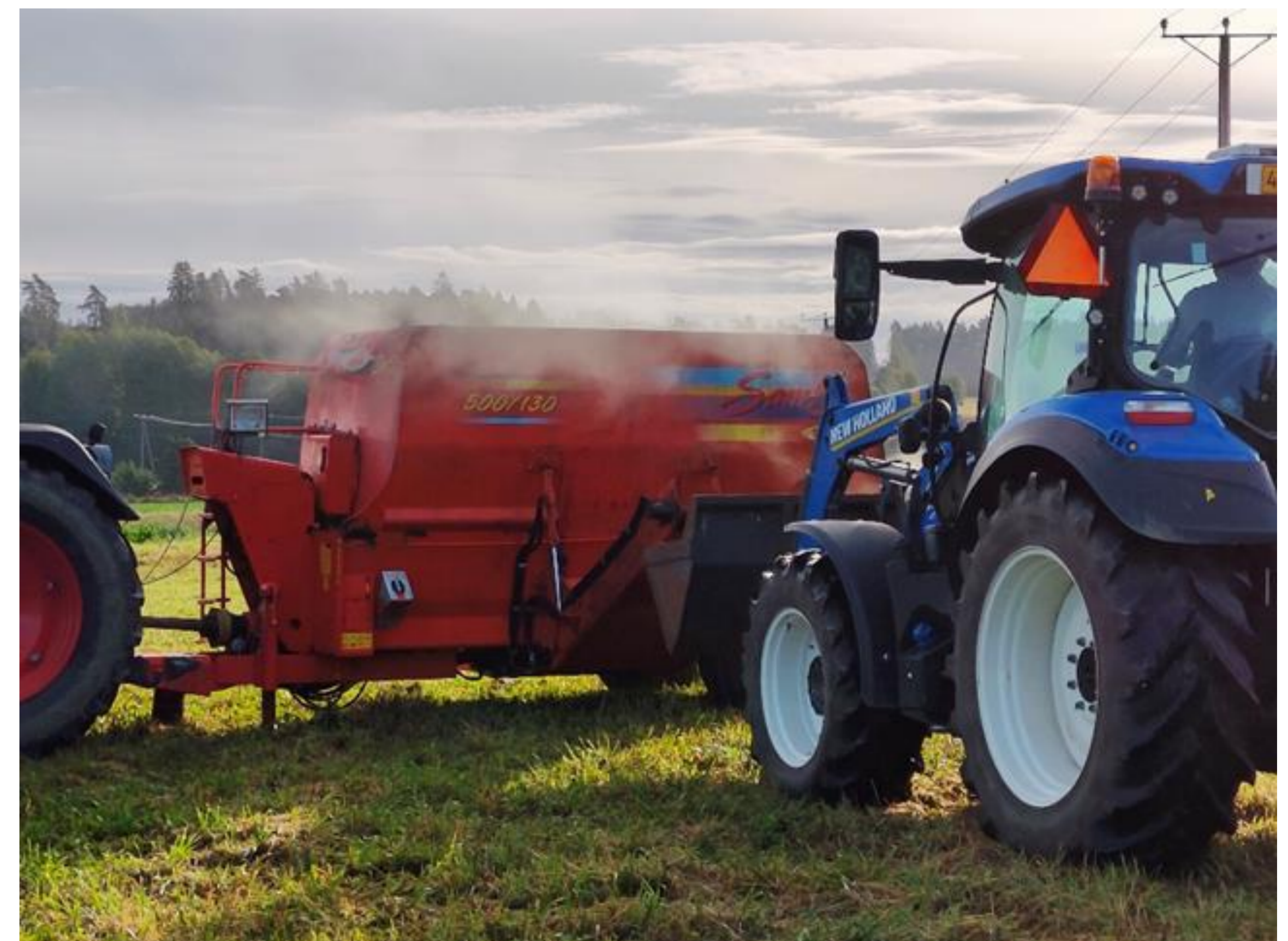
Kuva 2. Apevaunussa toteutetussa pikakompostoinnissa lämpötila nousi parhaimmillaan yli 60 °C.
