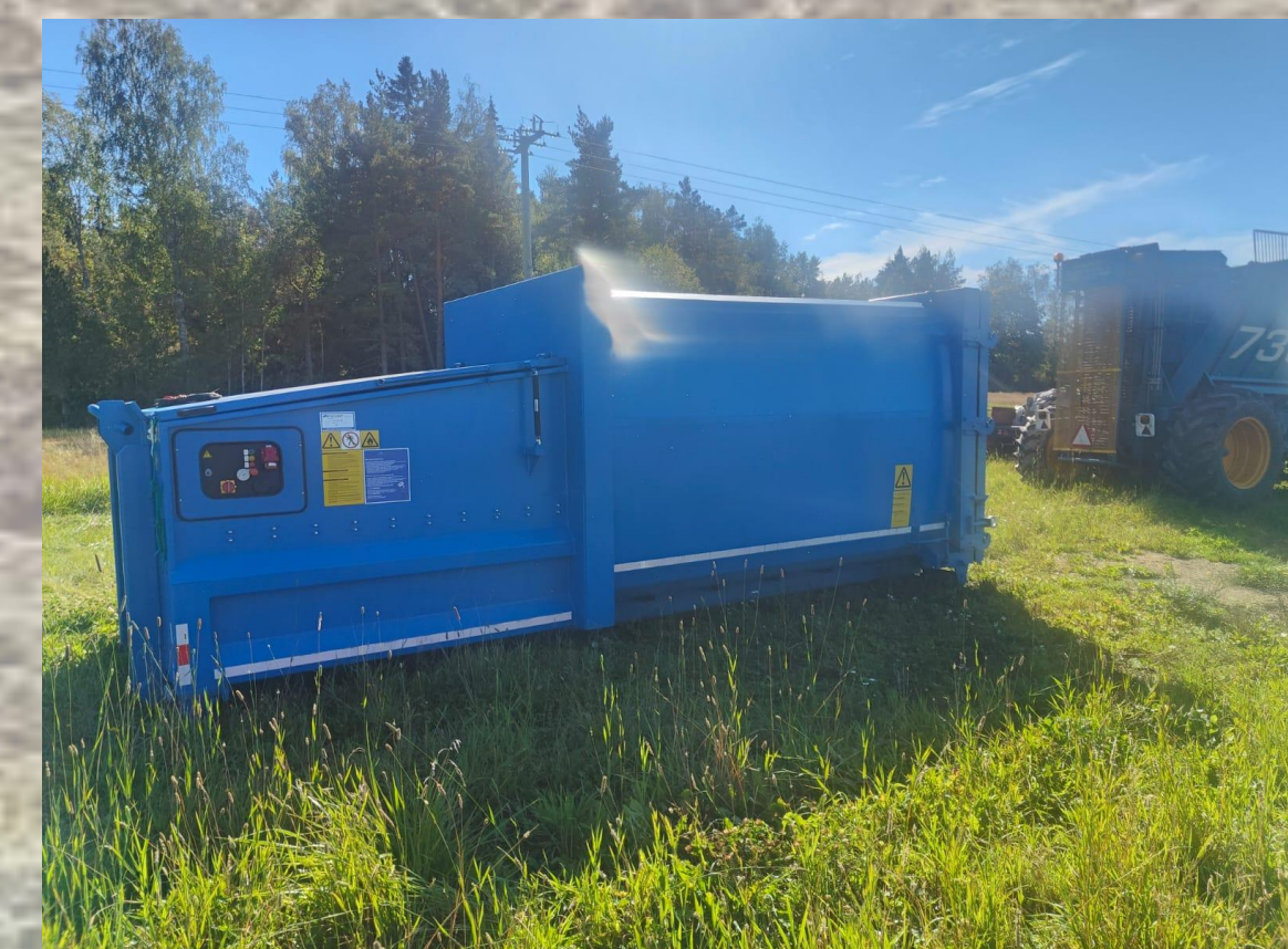
Kuva 2. Jätepuristimen käyttö sokerijuurikkaan naatin puristuksessa vaatii modifiointia ja suunnittelua. Neste voidaan ottaa talteen IBC-kontteihin.
