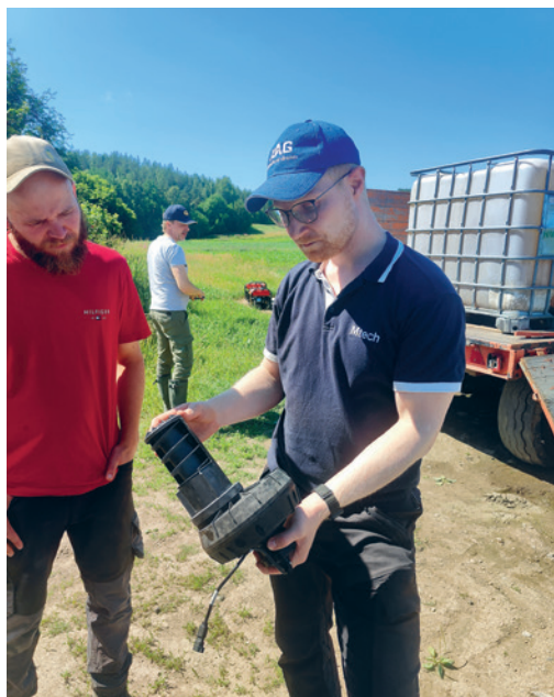
Kuva 3. Mikael Torvinen esittelee droonin lautaslevittimeen kuuluvaa syöttöruuvia.
