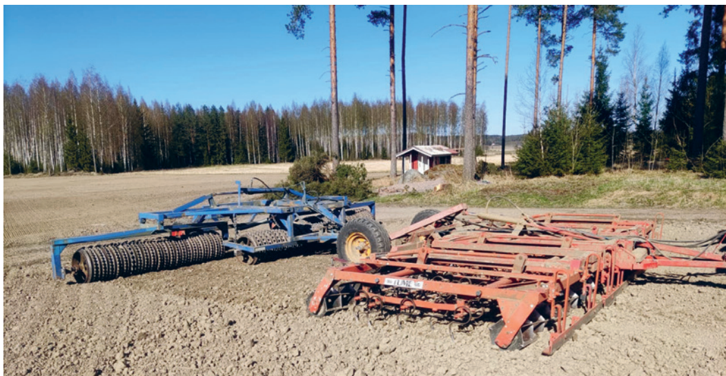
Kylvöpohja tehdään minipiikkiäkeen ja jyrän yhdistelmällä. (Jyrki Nummenpää)
